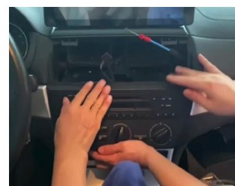
23. Bringen Sie das Bedienfeld der Klimaanlage wieder an und befestigen Sie es mit Schrauben.
