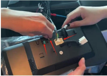
19. Stecken Sie alle Netzkabel in die Rückseite des Android-Bildschirms.
