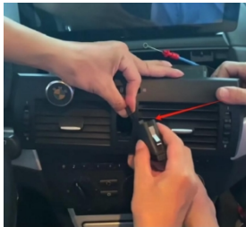
24. Installieren Sie die Doppelblitz-Taste wieder am ursprünglichen Luftauslass des Fahrzeugs
