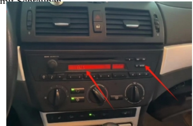
26. Drücken Sie die MODE-Taste des Radios, um Wählen Sie AUX für den Ton
