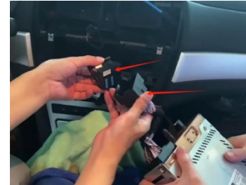
20. Schließen Sie das neue Netzteil an die ursprüngliche Stromversorgung des Fahrzeugs an.
