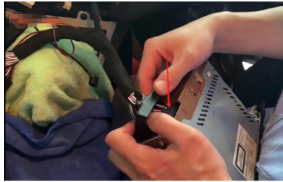
20. Schließen Sie das Netzkabel an die Haupteinheit des Fahrzeugs an.
