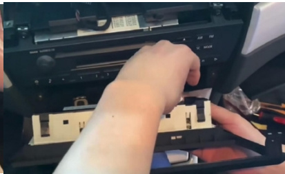
22. Installieren Sie alle Kabel hinter der Bedienfeldblende der Klimaanlage.
